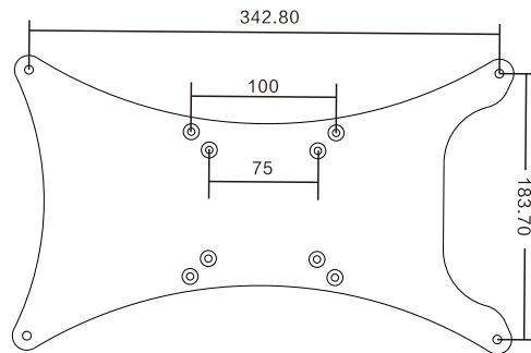
注: (1) 请先预埋11.8型4位暗盒后, 按下图尺寸打孔固定铁板, 再将设备挂于铁板的四个铁柱上。
