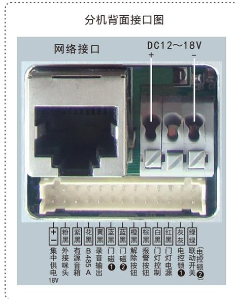
• 可根据客户需要改为联动开关使用，灰色、灰色线接报警联动设备。当分机被呼叫时，端口上有闭合信号输出（注：只有当分机启用保密功能时，收到呼叫后会有闭合信号输出，分机接听即解除）。
