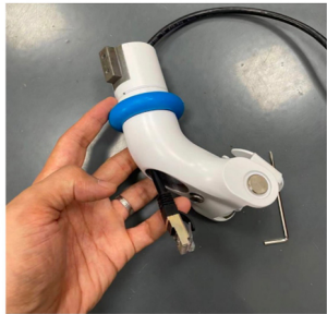
水晶头从底部椭圆孔拉出
