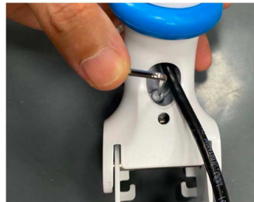
用S2.5六角扳手将螺丝拧紧
