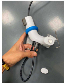
水晶头反向穿入底部椭圆孔
