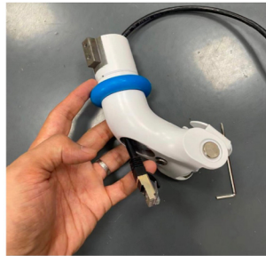
水晶头从底部椭圆孔拉出
