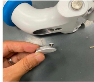
将底下椭圆塞块及螺丝取出
