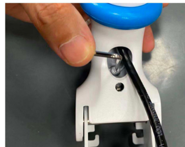
用S2.5六角扳手将螺丝拧紧
